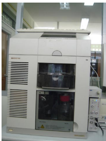
eDAQ C 4 D システムを Agilent 1600 CE に取り付けた装置全体の写真
