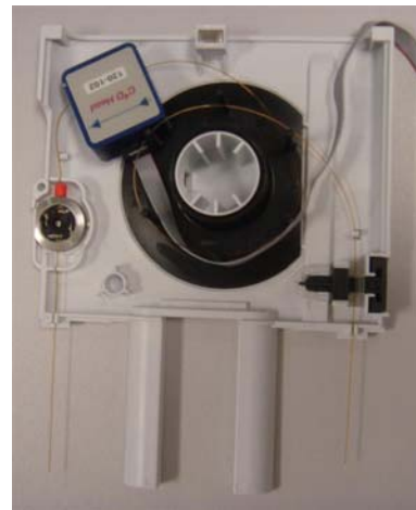
Agilent のカートリッジに C 4 D ヘッドステージを取り付けた写真。円形で銀色の UV 検出器のセルも映っています。
