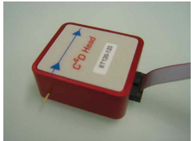
eDAQ 外径 150 \mu m 用の C 4 D ヘッドステージ
