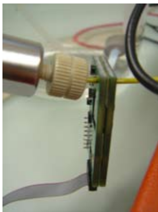
図 1. プラナーヘッドステージをカラム出口の1/16"チューブに接続
